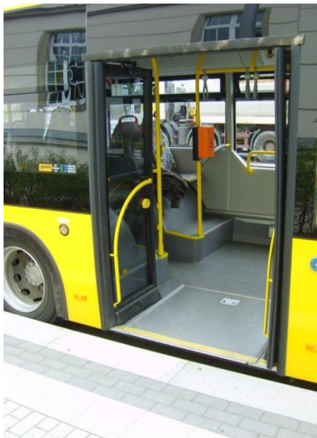
Rys. 9.8.2.2. Przerwa między peronem przystankowym a autobusem.
